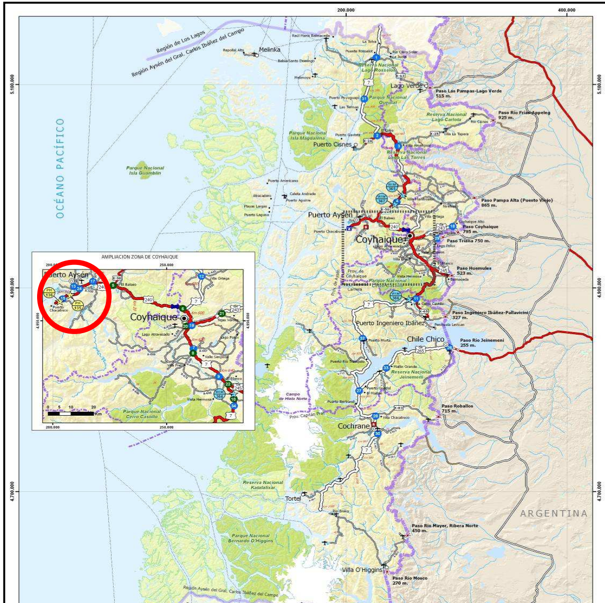
Figura 18: Volúmenes de tráfico en red vial regional, se destaca el tránsito medio diario anual (TDMA) de 39.000 vehículos hacia y desde el puerto de Chacabuco.
